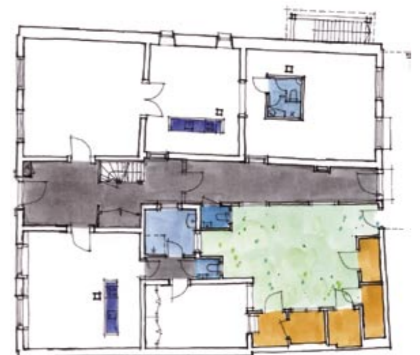
Sanitair staat los in de te verhuren units. Het monument wordt zo niet aangetast
